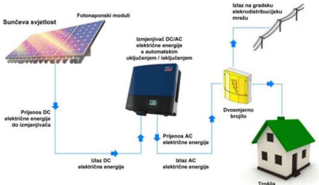
Slika 1. Fotonaponsko postrojenje spojeno na javnu mrežu
